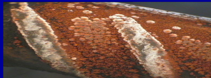
Μορφολογία χάλυβα S500s μετά από έκθεση σε υδατικό διάλυμα NaCl 3,5% κ.β. (x25)
